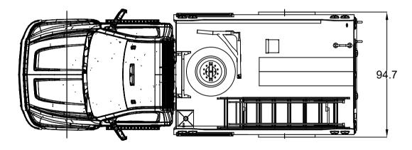
Tire: 255/70R22.5 Rollover Threshold: 30° Turning Radius: 26ft
